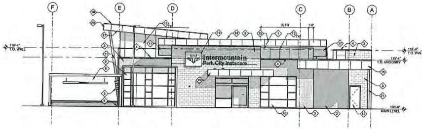
D5 SOUTH EXTERIOR ELEVATION SCALE: 1/8" = 1'-0"
